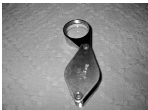
圖表 4：步驟三：鎖緊銅環，完成高倍率的放大鏡
