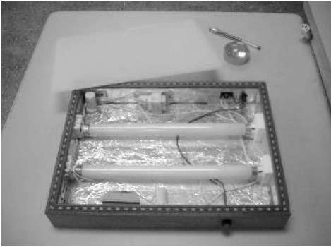
散光均勻用壓克力版下為兩支10W的日光燈管，內貼錫箔可使反光均勻。
