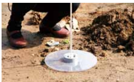
長谷川式簡易現場透水試驗器
