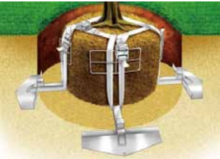
市售伸縮型支架承受約50m/sec，可讓環境美麗，為樹木安全的好選擇。
