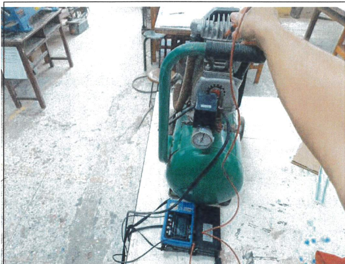
絕緣電阻量測
