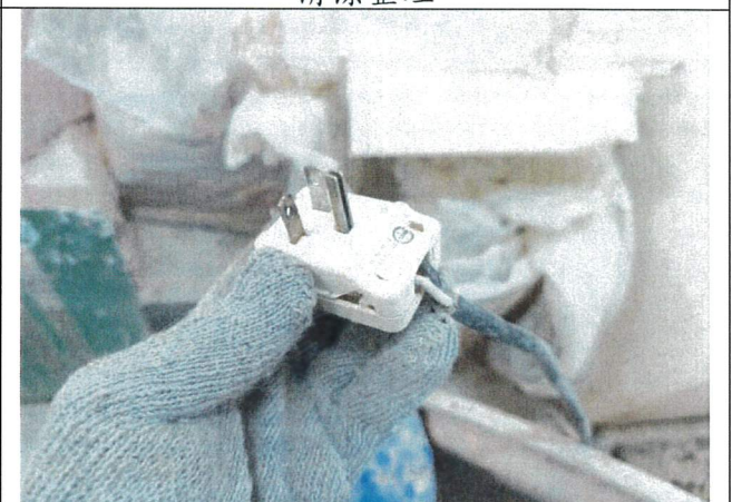
插頭損壞變形
